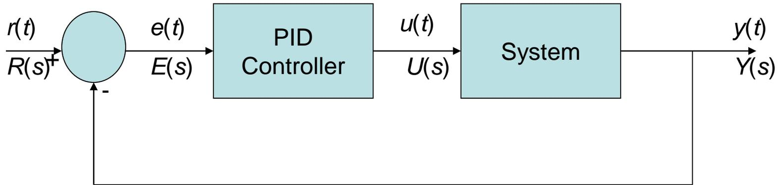
$$G(s) = \frac{Y(s)}{R(s)} = \frac{G_{sys}(s)G_{PID}(s)}{1 + G_{sys}(s)G_{PID}(s)}$$
