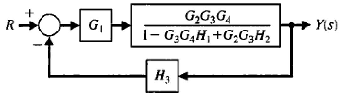
$$\frac{R(s)}{\frac{G_1G_2G_3G_4}{1 - G_3G_4H_1 + G_2G_3H_2 + G_1G_2G_3G_4H_3}} = Y(s)$$
