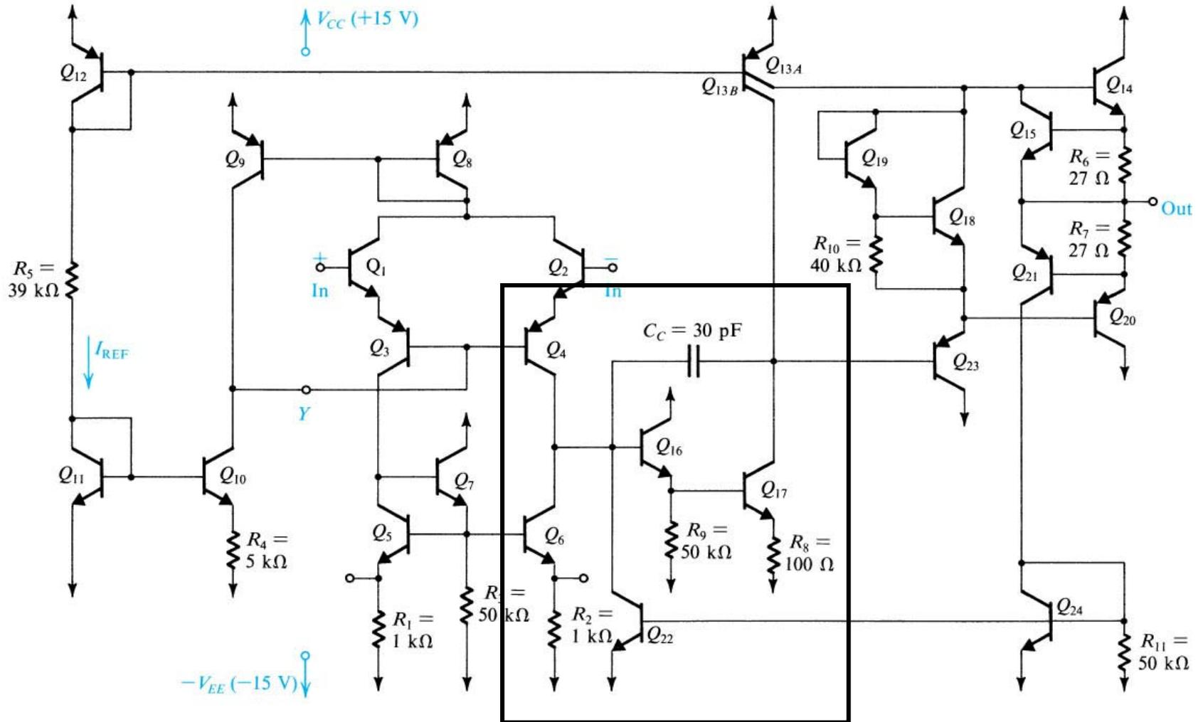
$$A_d = -g_m(r_{o4} // R_{ac1} // R_{i2}) = \frac{I_{CQ}}{V_T}(r_{o4} // R_{ac1} // R_{i2})$$
