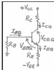
$$-V_{EE} + I_B R_B + V_{BE} + I_E R_E = 0$$
