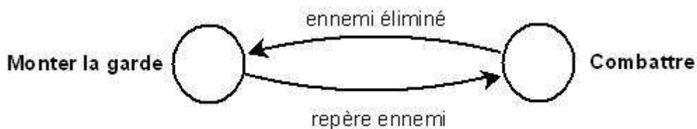
Figure 3 : Exemple de machine à état fini
