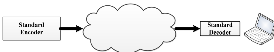
شکل ۱-۶ ساختار کلی یک کدکننده تک لایه در سمت سرویس دهنده و یک کدگشای تک لایه در سمت گیرنده
