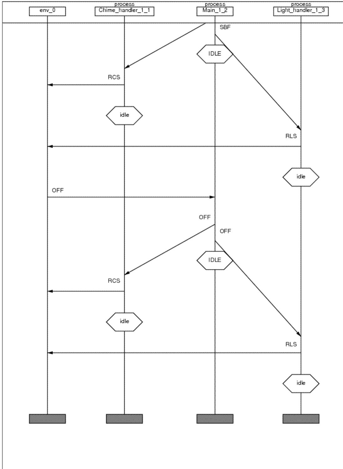
15. Le diagramme ci-haut est un MSC pour le logiciel qui contrôle l'allumage et l'arrêt d'une lumière d'alarme et le signal sonore quand la voiture est utilisée sans que la ceinture de sécurité soit utilisée sur le siège du conducteur. Voici une description de ce système:
